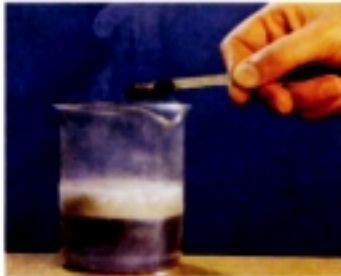
تفاعل الماغنسيوم مع حمض الهيدروكلوريك شكل (٤)
